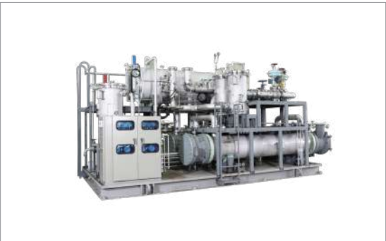
Systém vodního chlazení statoru
