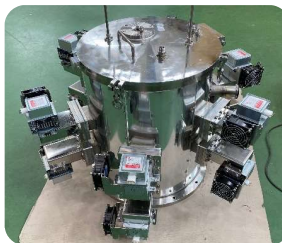
Actual Microwave Heating Reactor
